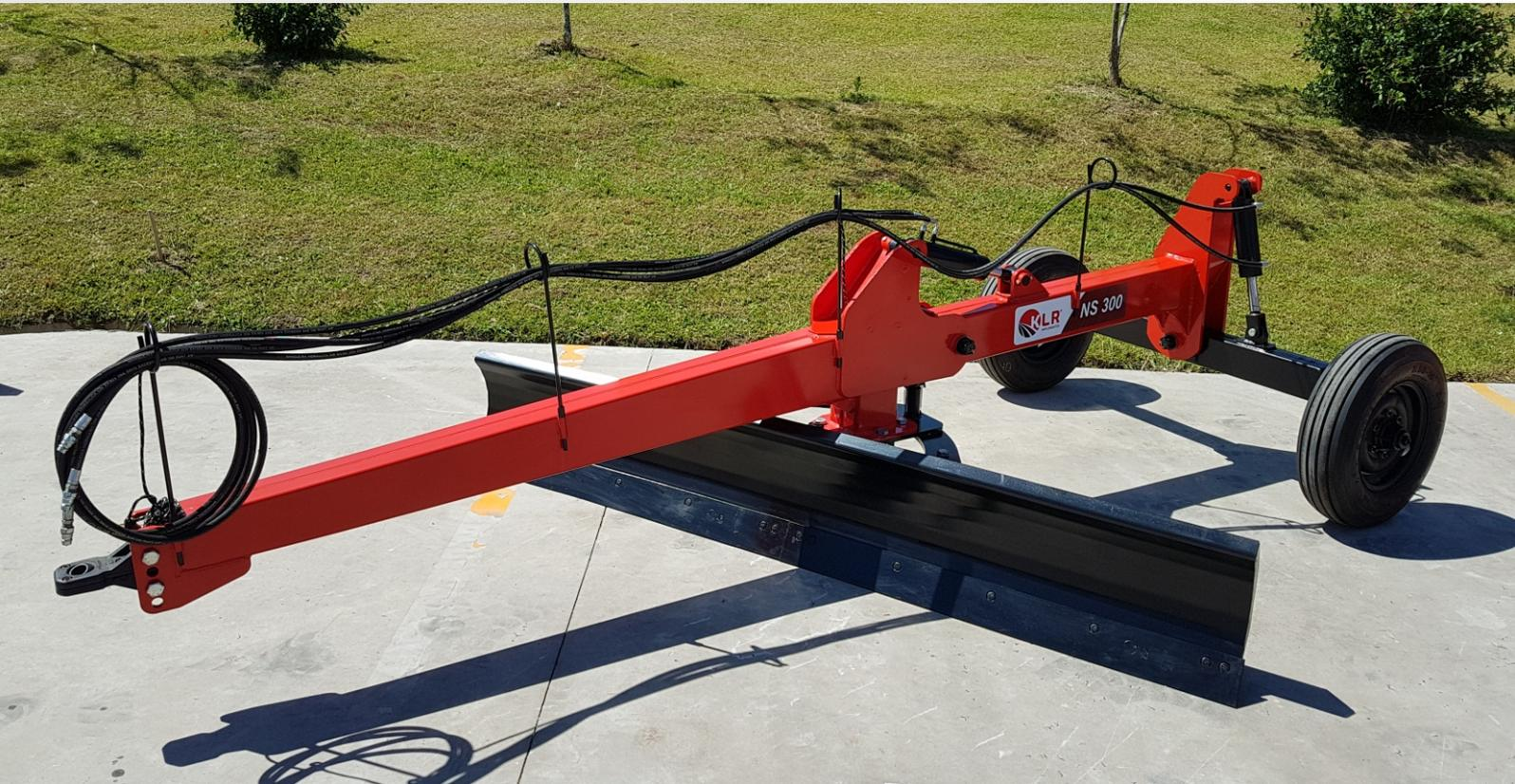
**Chasis Estructural Reforzado con Control Remoto en la posición del ángulo vertical y Profundidad de trabajo;
